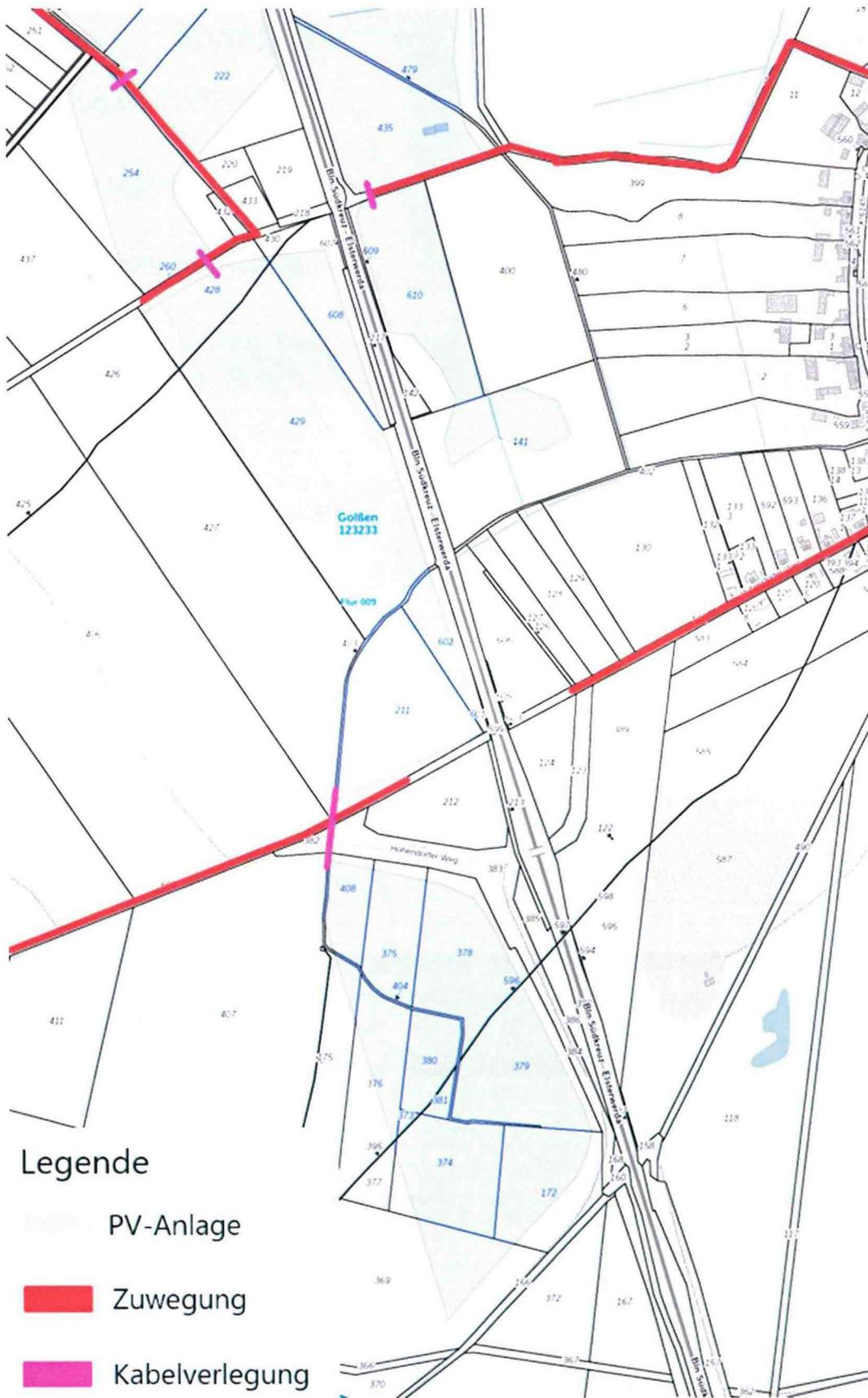
**Anlage 2b: Endgültiger Lageplan des Standortes der PVA mit Zuwegung und Kabeltrasse**
